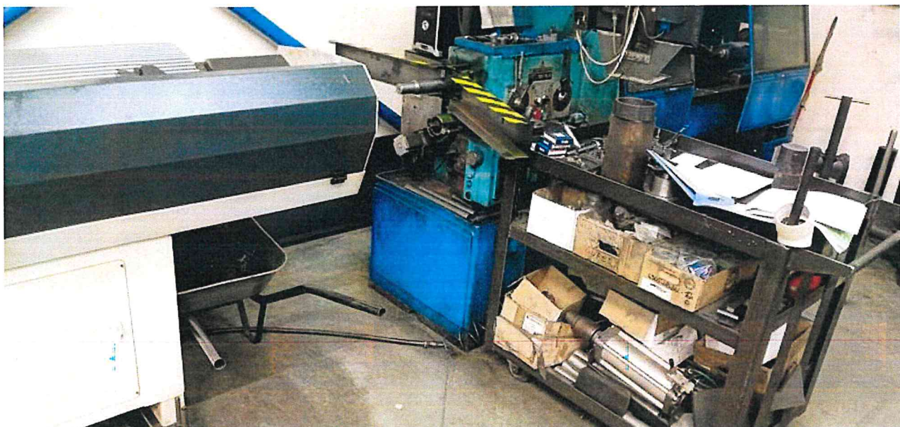
Obrázek 2 - Pohled na soustruh s vyčnívajícím dorazem (dodatečně namontovaný šrafovaný kryt)
