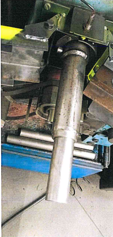
Obrázek 3 - Pohled na doraz soustruhu ze shora (patrná pevná a pohyblivá část dorazu)
