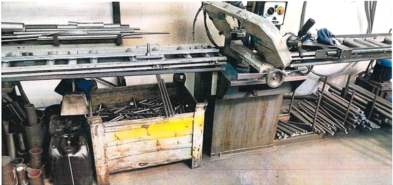
Obrázek 4 - Pracoviště č. 4 - malá pila s umístěnou bednou na odpad
