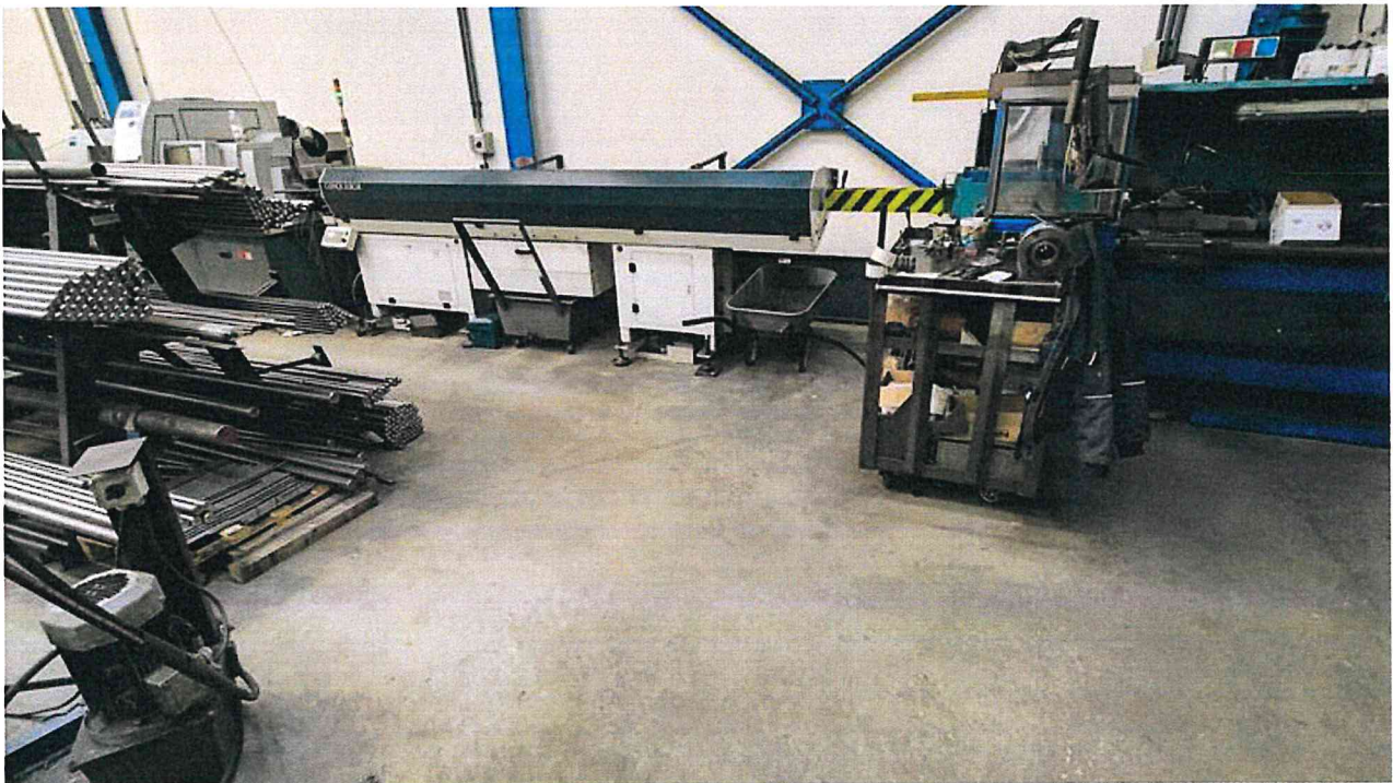
Obrázek 1 - Celkový pohled na pracoviště (vpravo soustruh SV18RA, vlevo dělicí stroj tyčového materiálu pod kterým je umístěno kolečko)
