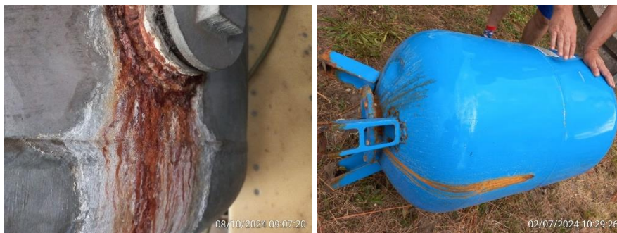
Obrázek č. 18a a 18b - Nedostatky v údržbě vnějšího pláště nádob
