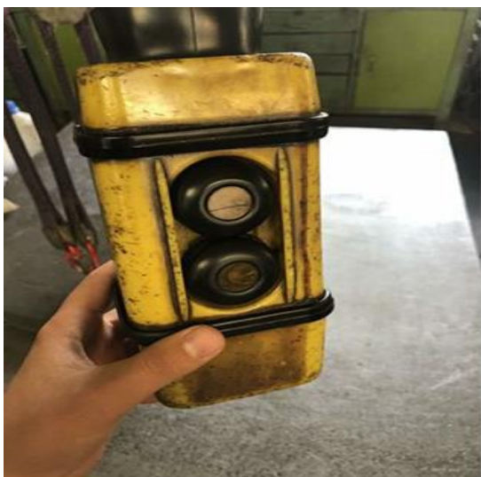
Obrázek č. 12 - Poškozená tlačítka dálkového ovládání
